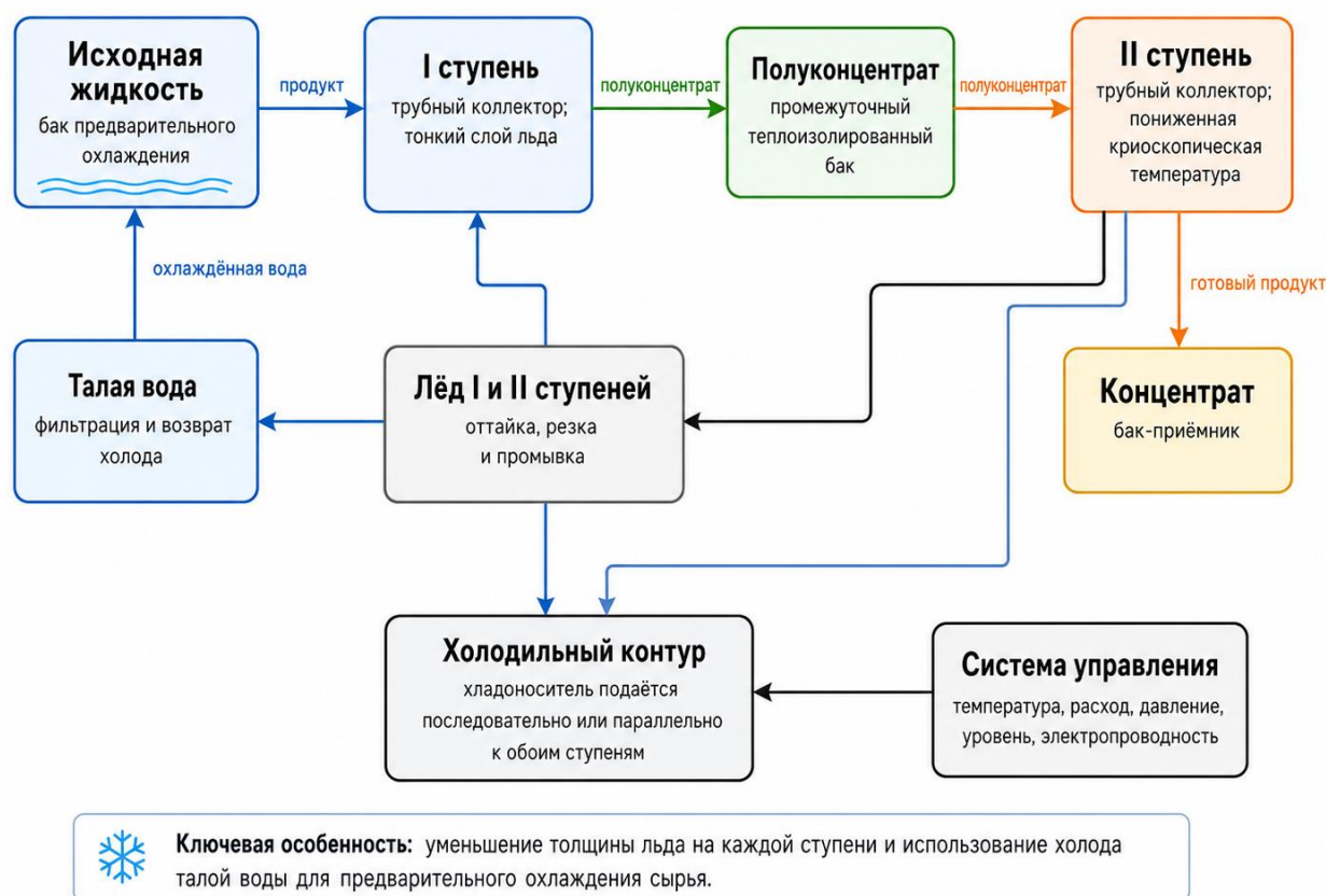
Рисунок 10 – Функциональная схема двухступенчатого емкостного криоконцентратора с предварительным охлаждением и возвратом холода
