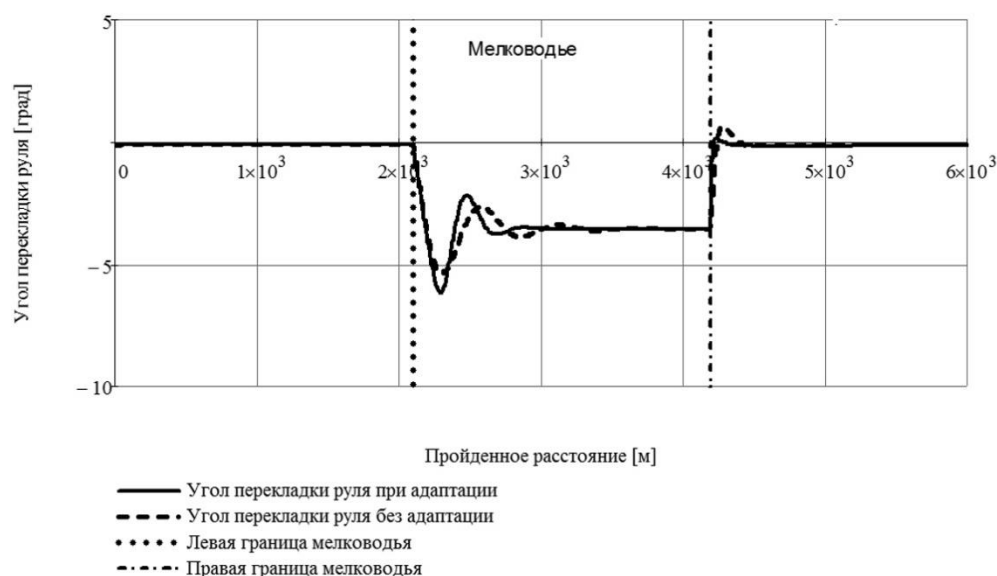
Рисунок 4.2.5 – Графики изменения угла перекладки руля в процессе адаптации и без адаптации
