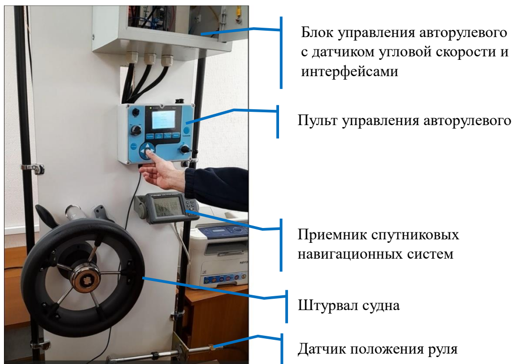
Рисунок 1.5 – Оборудование авторулевого в процессе тестирования на испытательном стенде
