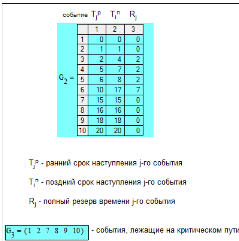
Рисунок 2.12 – Расчет сетевого графика методом CPM в Mathcad с применением программного блока (окончание)
