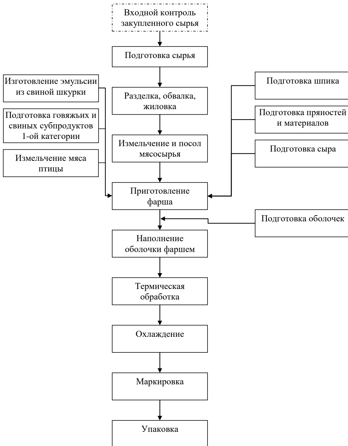
Схема 2.1. Блок-схема процесса производства изделий колбасных вареных
