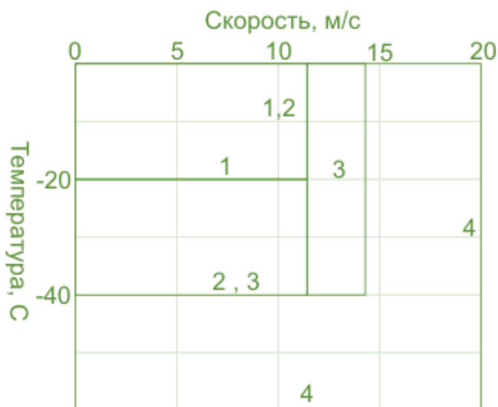
Рисунок 2 - Границы рабочего режима кранов в зависимости от жесткости погоды:
