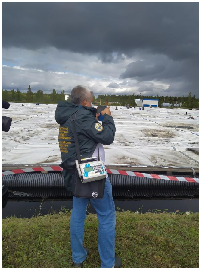
Фото 9. Измерение радиации, рядом с картой жидкой фракции, покрытие способствует минимизации образования дополнительной жидкой фракции.
