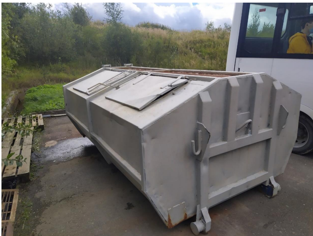
Фото 8. Контейнер для шлама, образующегося при очистке жидкой фракции.
