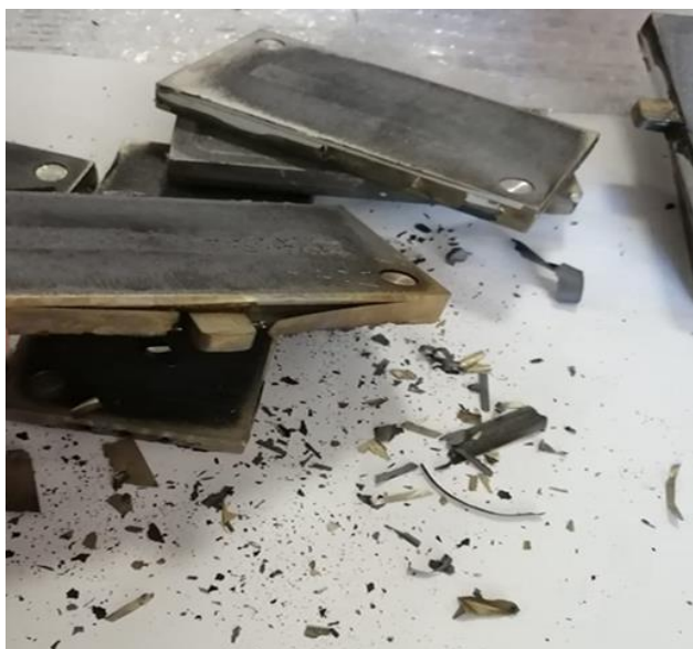
Рисунок 4. Разрушение предварительно нанесения гальванопокрытия в процессе диффузионной сварки
