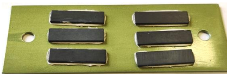
Рисунок 6. Ферритовые пластинки на кремнийорганическом силиконовом клее
