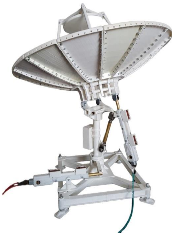
Рисунок 5. Макет двухзеркальной антенны в масштабе 1:16
