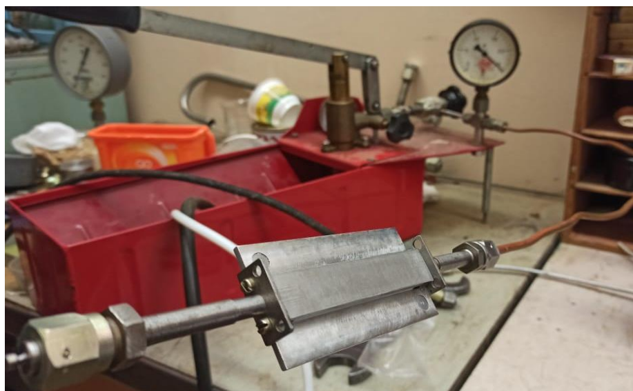
Рисунок 3. Опрессовка сварного соединения
