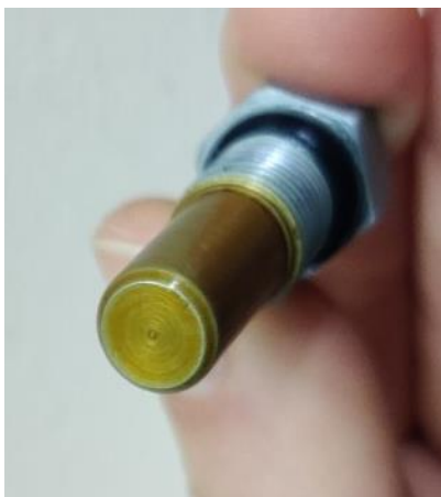
Рисунок 5. Образец после воздействия ОЖ-65 «Лена»
