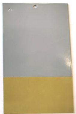
Рисунок 3. Внешний вид покрытия эмалью ЭП-140 по лаку
