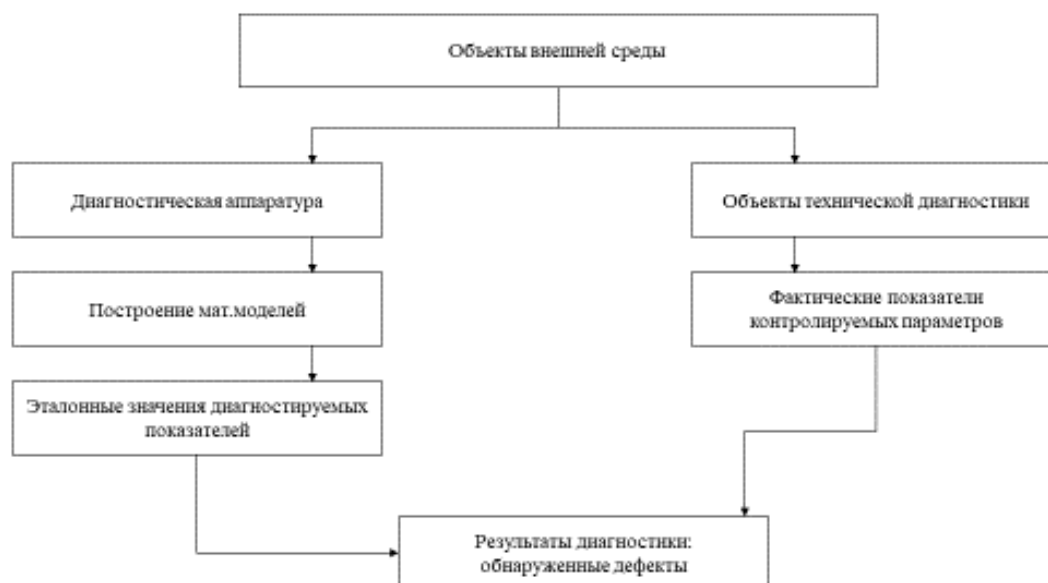
Рисунок 1.1 – Схема взаимодействия базовых элементов технической диагностики
